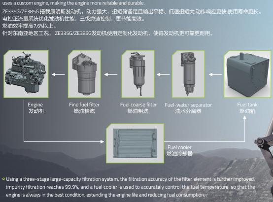
采用三级大容量过滤系统,滤芯过滤精度进一步提升,杂质过滤达到 99.9%,并且使用燃油冷却器,精准控 制燃油温度,使发动机始终处于最佳状态,提升了发动机寿命的同时,降低了燃油消耗。
